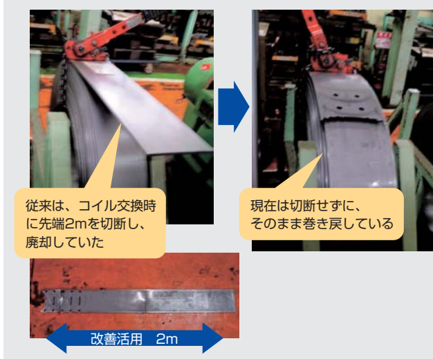
■図1：コイル交換時の切断廃止
