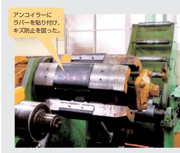
■図2：キズ発生によるムダの削減
