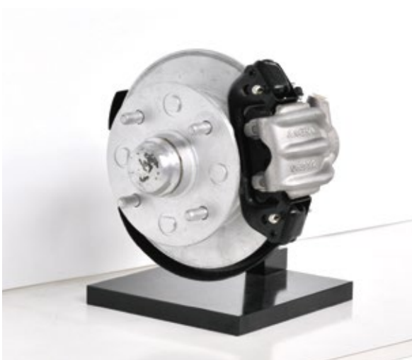
当社初の量産ディスクブレーキ「F型」(日野コンテッサ)(1964)
