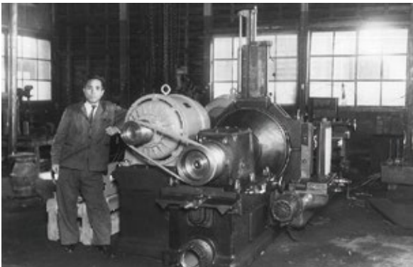
クラッチフェーシングの両面研磨機完成(1955)
