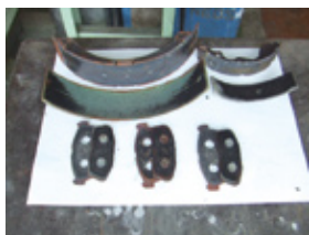
剥離： 剥離されたブレーキシュー(上)と ブレーキパッド(下)
