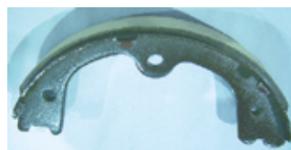
岩槻製造(株)の非VOC接着工法によるシューアッシー
