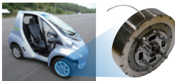
MR流体ブレーキ（試作品）とそれを搭載した超小型モビリティ
