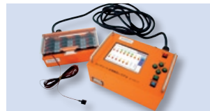
■ コンクリート充填検知システム
