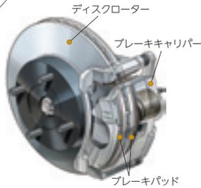
車輪とともに回転するローターにピストンの力でパッドを押しつけ、その摩擦力を熱に換えることで自動車のスピードを下げ、停止させるブレーキシステム
