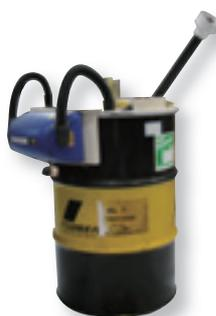
バルブクラッシャー:3重のフィルターでガラス、金属キャップなどをまず分離回収し、水銀は不溶固体である硫化水銀にして安全に回収しています
