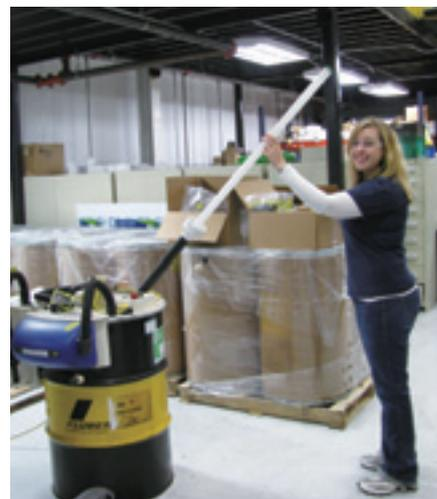
廃蛍光管を投入口から入れて破砕処理します
