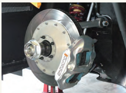
フロントキャリパー:6ピストンモノブロックキャリパー
