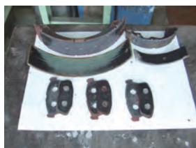
剥離： 剥離されたドラムブレーキシュー(上)と ディスクブレーキパッド(下)
