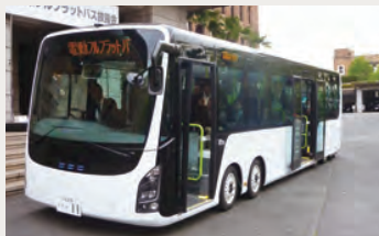
電気自動車「Elica」の開発技術に応用した電動低床フルフラットバス (写真提供: 共同通信社)
