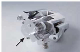
中央矢印部分が電動機構部分
