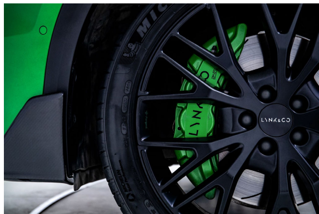
Lynk & Co 05+用オポーズドタイプ 4 ポットディスクブレーキキャリパー
